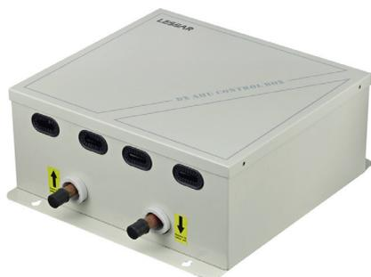
Контроллер фреоновых секций приточных установок LZ-AHU позволяет подключить фреоновую секцию приточной вентустановки к наружному блоку мультизональной системы LMV. Контроллер позволяет работать с одноконтурной системой до 56 кВт и с двухконтурной системой до 90 кВт.
