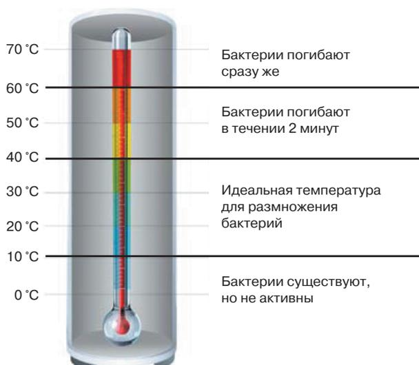
Для борьбы с бактериями использование одного лишь хлорирования в системах горячего водоснабжения недостаточно, так как существуют бактерии довольно устойчивые к хлору. Именно поэтому в аккумуляторных баках систем **LESSAR Heat Pump** введена функция автоматиче-
